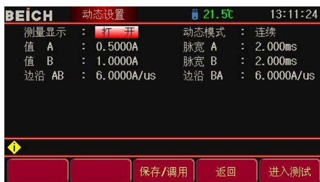
动态测试能够使负载在两种负载电流间按斜率以及脉宽时间反复切换，此功能可用来测试电源的动态特性。
