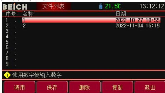
通过存储与调用功能, 可以即时保存参数, 将测量设置保存到内部ROM或外部USB存储器, 保存测量结果或屏幕快照到外部USB存储器。
