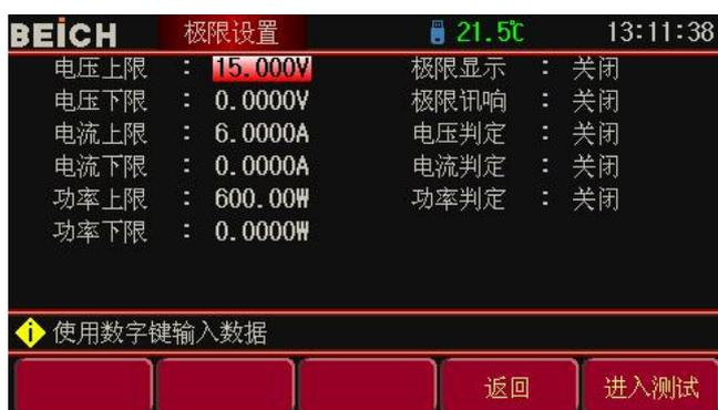
该页面下可以设置电压，电流，功率判断的上下限参数以及相应的判断功能打开与关闭。常态界面启动测试后可在主测试界面显示区域内显示极限参数以及判断结果，超过设置值的会以红色反显提示，屏幕左侧的指示灯也会根据判断结果做出亮灭，此外仪器后端的PASS/FAIL输出口也将输出相应信号。
