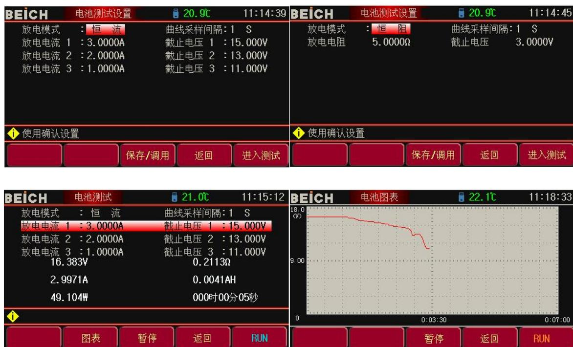
放电测试可以以恒流或恒阻方式工作，以测定电池类电源的放电时间及容量；持续放电过程中，电池电压不断跌落，当负载输入电压低于设定值时，放电测试自动停止，仪器可显示放电时间及电池容量。仪器最多可以设置三档放电电流及截止电压，以能更好的模拟实际电池在不同电流应用下的状态，放电电流 1 在达到条件后会自动转为 2 直至 3，所以在设置截止电压时也要按电压下降梯度，截止电压 3 不能高于 2 不能高于 1。
