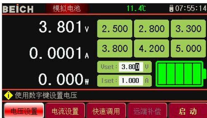
当外接用电设备时，模拟电池测试仪输出电能，即输出放电。通过外接移动电源 PCBA 板等电池放电设备，可以测试电源产品 PCBA 的放电性能。亦可当作普通可调电源为用电设备供电。当输出电流小于 10mA 时，系统将自动转为电流低量程工作，此时显示屏电流单位为“mA”最小可显示 0.1uA 电流。电流输出时显示屏显示电流为 0.0000A 格式。
