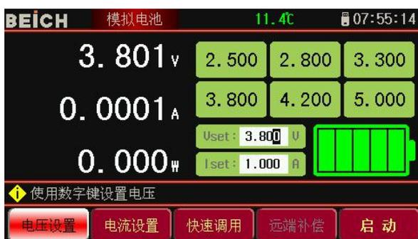
快速调用按键按下后光标会移动到 6 组快速电压电流预置上面，按下光标停留的按键后会显示出设置对话框，可以用来修改快速调用的电压和电流值，修改参数时直接按数字键盘对应数字后按【ENT】键确认。
