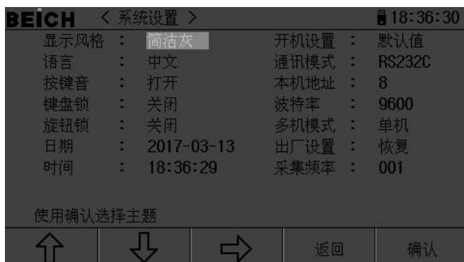
该界面下可以设置和更改功率计系统风格及应用，按【Ent】键切换光标处菜单内容，日期与时间直接按数字键后按【Ent】键确认。
