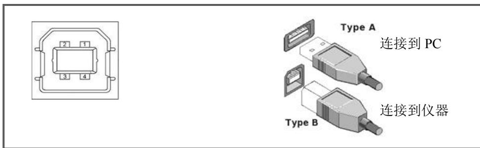
将仪器通过 USB 连接到 PC 后，按照使用的 USB 通讯模式，需要在 PC 上安装不同的驱动程序后才能使用。**USB-CDC**
