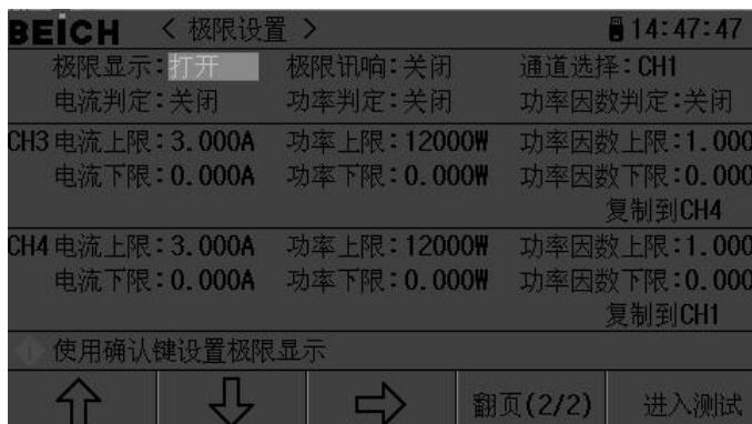
该页面用于设置各项比较参数，以及比较器的状态，光标在数字参数时直接按数字键盘输入参数，光标在文字区域时按 ENT 键切换显示项目。
