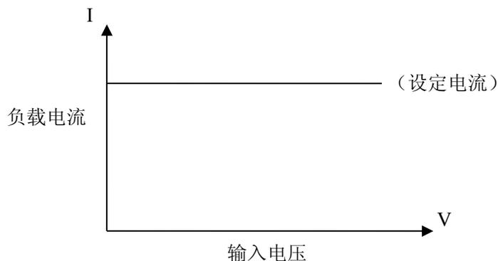
按【定电流】键进入定电流模式，该按键灯亮起，通过数字按键输入需要设定的电流值，输入的数字会在状态栏
