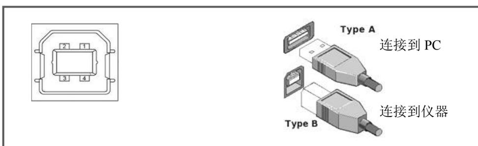
将仪器通过 USB 连接到 PC 后, 按照使用的 USB 通讯模式, 需要在 PC 上安装不同的驱动程序后才能使用。**USB-CDC**
