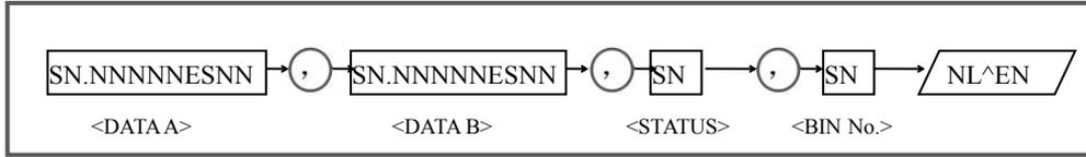
上图中，“，”号为数据间的分隔符，NL 为行结束符（0x0A），表示字串结束；^END 为 IEEE-488 总线的 EOI（结束）信号，本仪器从 GPIB 上发送的信息都是在发送行结束符的同时驱动 EOI 信号。RS232C、USB-CDC、USB-TMC 时没有这个信号，只有行结束符。
