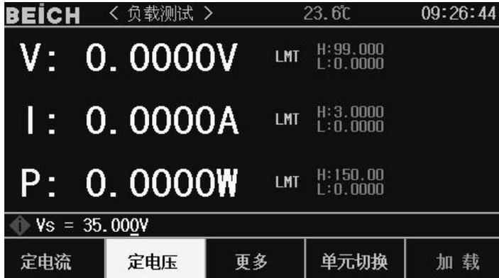
本机拥有强大的电子负载测试功能，完善的定电压（CV），定电流（CC），定电阻（CR），定功率（CP），CR-LED，等测试模式满足常规应用，电子负载测试模式下可单独进行负载项的列表测试。
