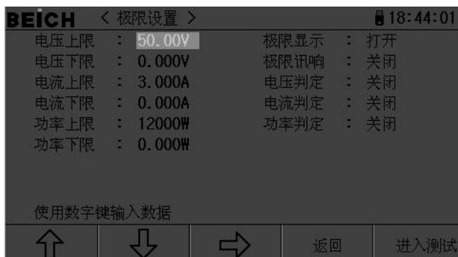
该页面用于设置各项比较参数，以及比较器的状态，光标在数字参数时直接按数字键盘输入参数，光标在文字区域时按 ENT 键切换显示项目。
