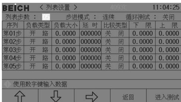
列表测试功能可实行在不同的负载模式下按设定的时间自动转换。
