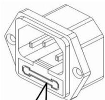
1. 保险丝位于电源插座下方，更换时首先拔下电源插头
