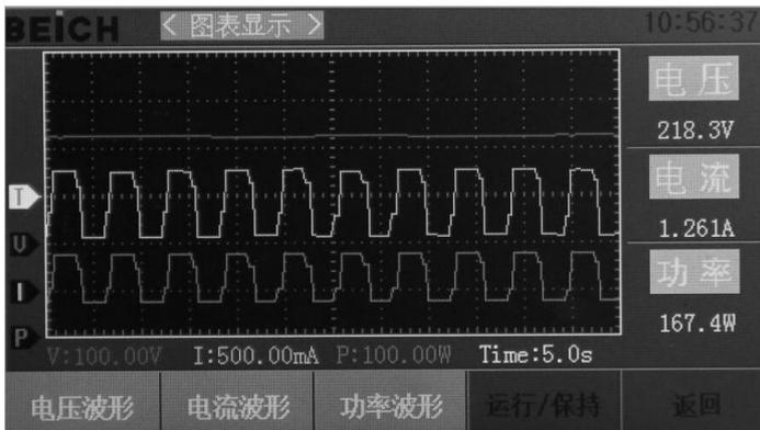
该页面下可以查看电压，电流及功率波形，波形幅度可以调整。调整幅度可以用  $\Delta$   $\nabla$  上下按键选择到需要调整的类目，类目包含时间 (T)，电压 (V)，电流 (I)，功率 (P)，位于图标左侧显示，光标选择到对应项时实时幅度会以突出颜色显示，左右旋转旋钮可改变幅度，光标右箭头对应的为该项的基准线。时间最小幅度 200mS，最大幅度 50S。电压最小幅度 100mV，最大幅度 500V。电流最小幅度 10mA，最大幅度 10A。功率最小幅度 100mW，最大幅度 5kW。用【运行/保持】按键启动或停止。图标右侧显示实时的电压，电流，功率参数。
