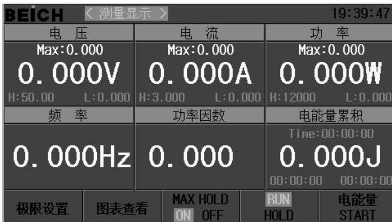
该功能可以自动记录电压，电流及功率的峰值，用对应按键打开或关闭该功能。
